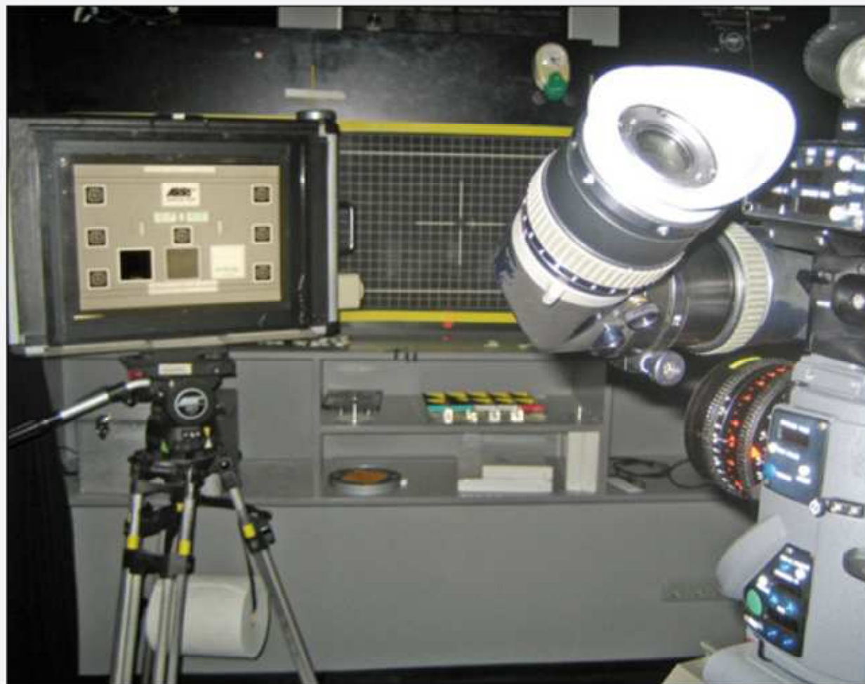
Filmoteka Narodowa, Warszawa, 2014. Test rozdzielczości negatywu filmowego 16mm i 35 mm.
