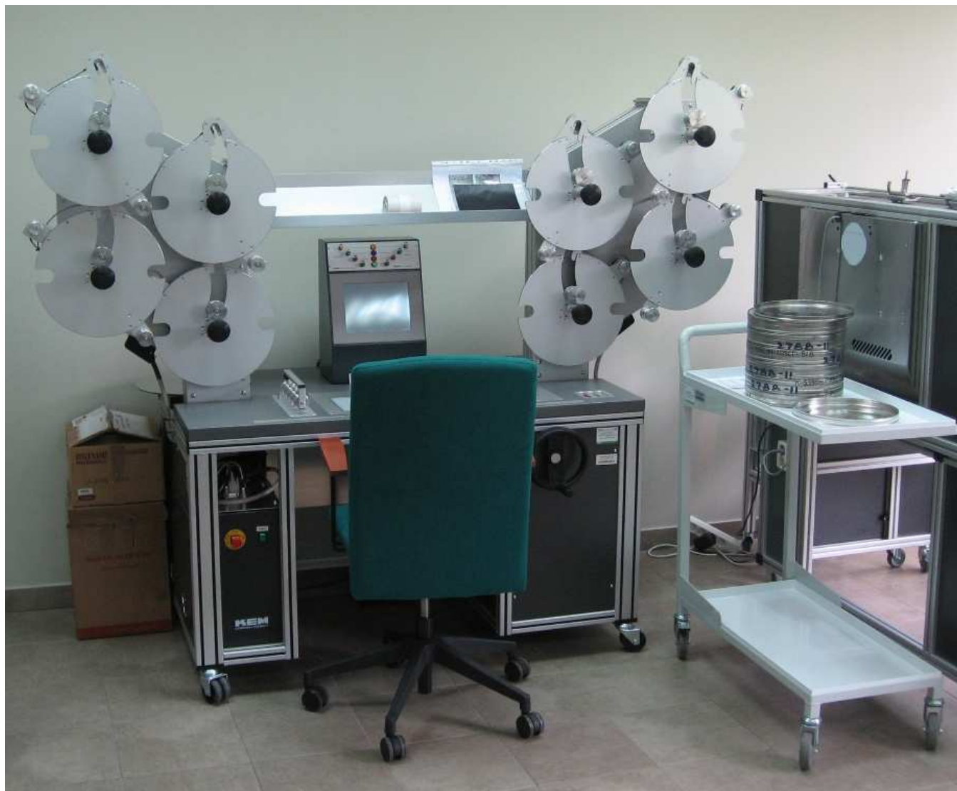
Stół synchronizacyjny (KEM) – konserwacja manualna taśmy filmowej
