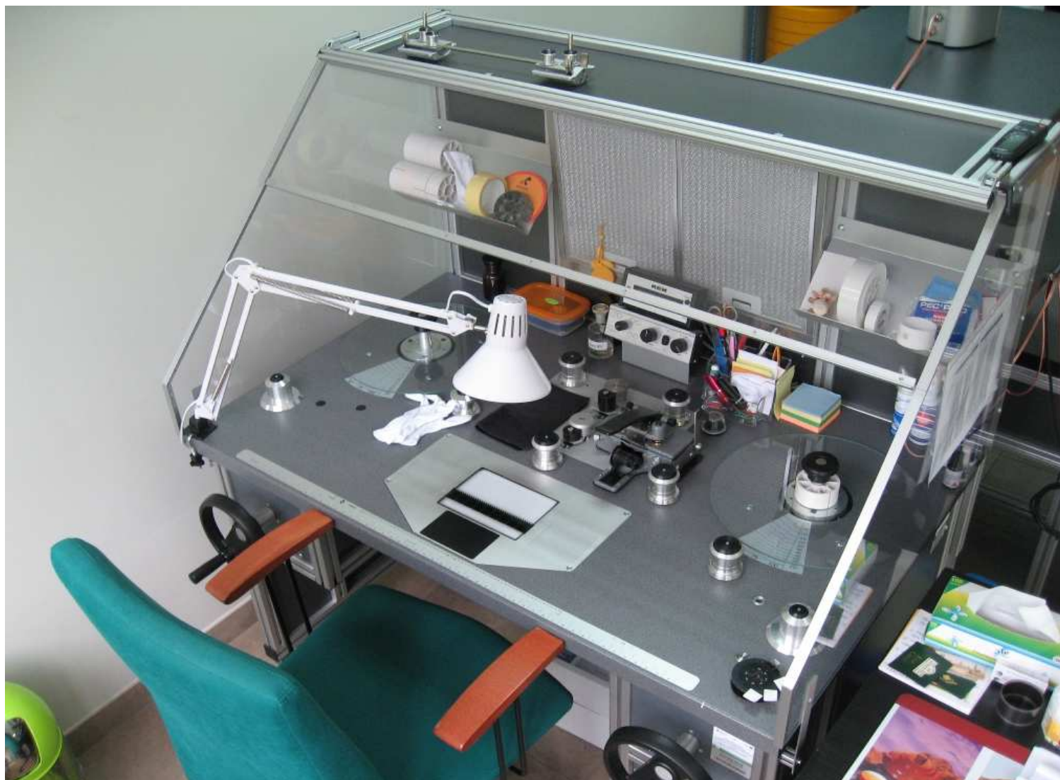
Stół mechaniczny (KEM) – konserwacja manualna taśmy filmowej
